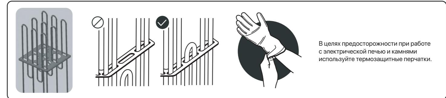
В целях предосторожности при работе с электрической печью и камнями используйте термозащитные перчатки.
